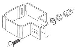
Colliers pour poteaux d'extrémités Decofor. Galvanisés et plastifiés (polyester) avec boulon de sécurité en inox et écrou autocassant type M8. Fixation des panneaux ENTRE les poteaux.
